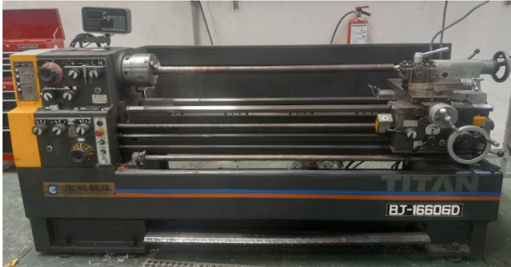
Figura 13. Torno manual marca BAOJI modelo BJ-1660GD
