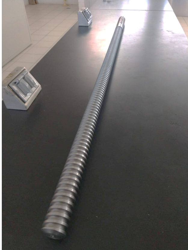
Figura 38. Vista completa del husillo con alabes maquinados.
