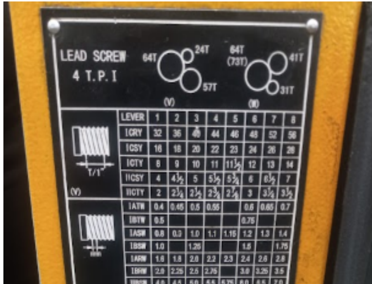
Figura 17. Configuración de los parámetros del torno para la generación de rosca tipo ACME.
