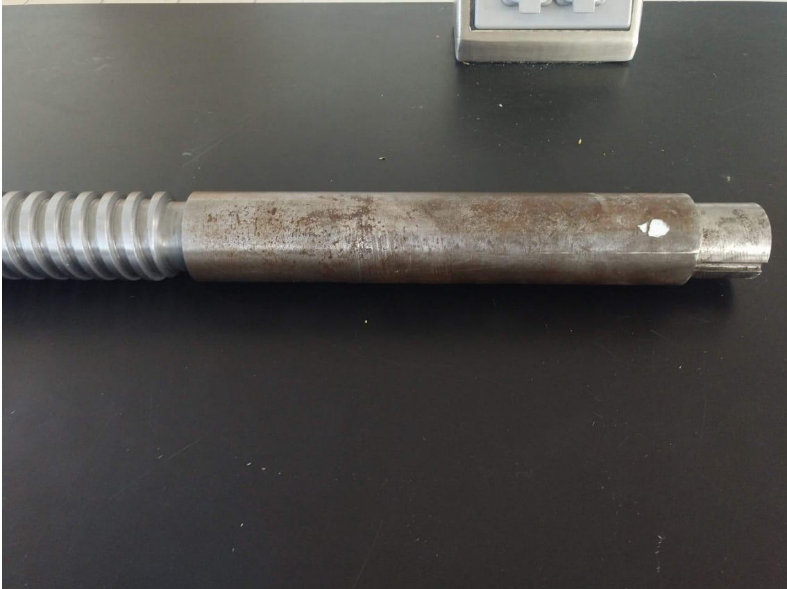
Figura 41. Cuello del husillo con ranura para comunicación con sistema de empuje.
