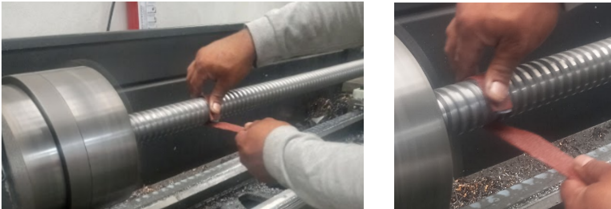
Figura 20. Lijado del husillo con el fin de eliminar filos
