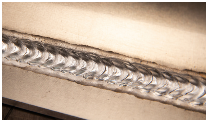
Figura 8. Resultado y acabado de la unión de dos piezas soldadas correctamente
