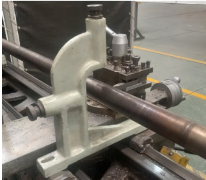
Figura 15. Luneta viajera, permite disminuir la vibración y evitar la elongación
