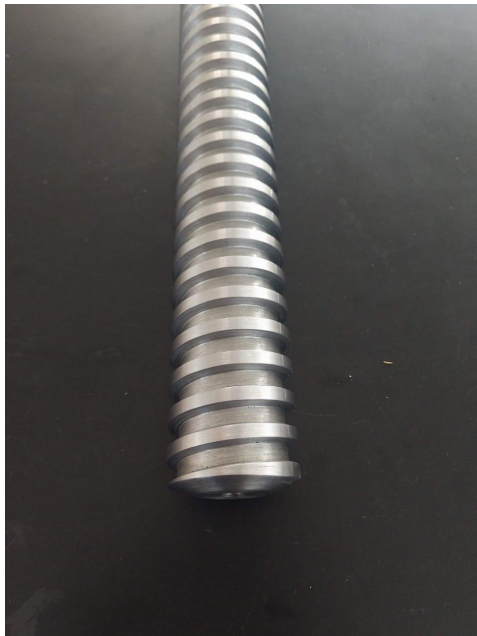
Figura 39. Acercamiento de alabes maquinados (punta del husillo).
