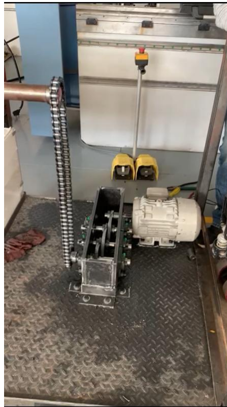
Figura 23. Sistema de empuje mecánico de la extrusora.
