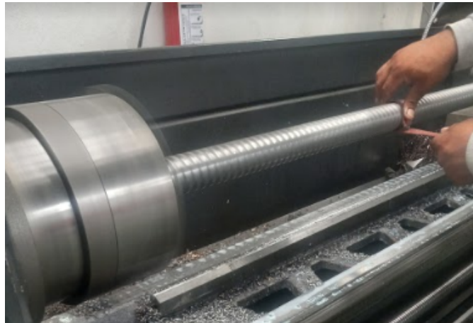
Figura 37. Eliminación de filos en los alabes del husillo.
