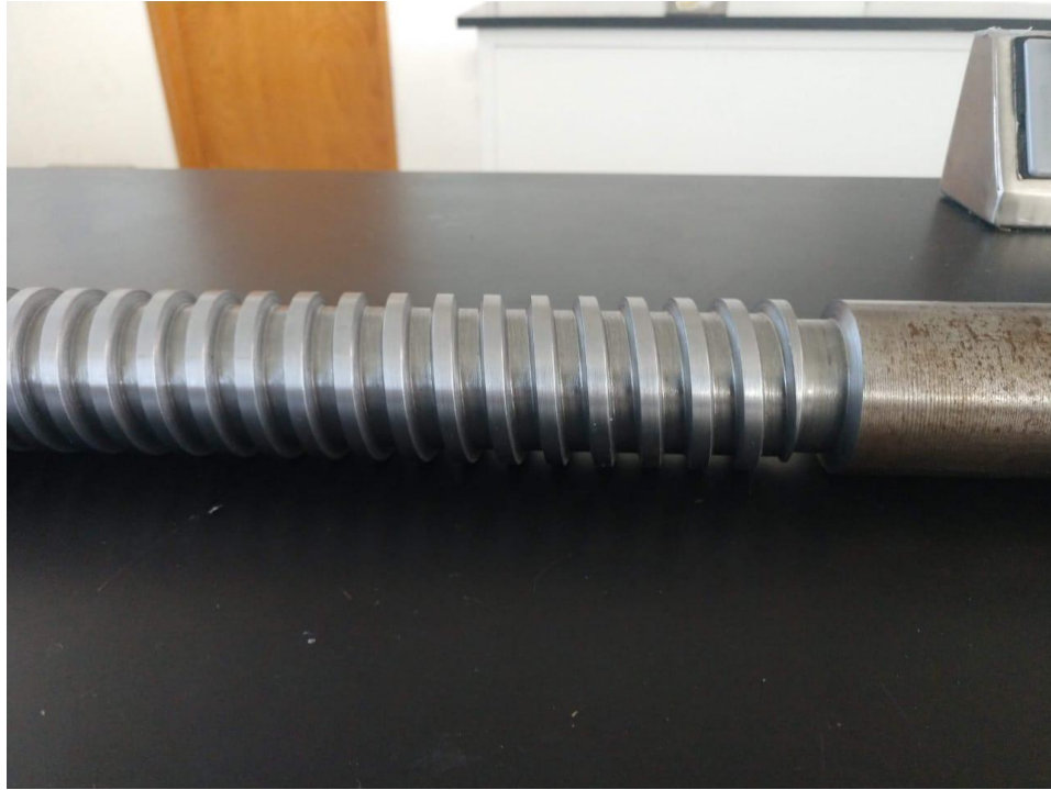
Figura 40. Acercamiento de álabes maquinados (extremo del husillo adjunto al cuello).
