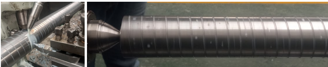
Figura 18. Inicio del desbaste para la generación de la cuerda ACME.
